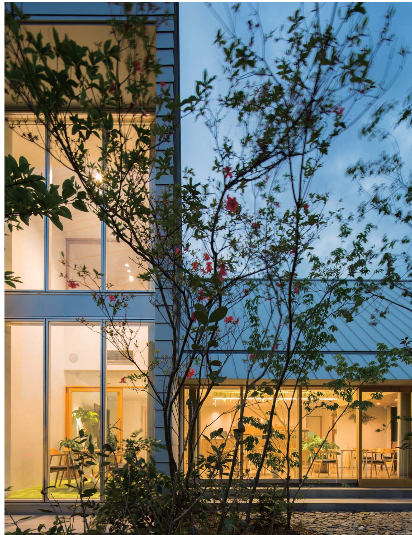
ふたつの異なる吹き抜け空間をを外部から見る。客席としても利用するホールは、サッシの高さをFL+2170に抑え、水平に広がり繋がることを意識している。ドローンの展示空間と打合せスペース2は、垂直方向を意識し、空へ向かって伸びやかに繋がる。
