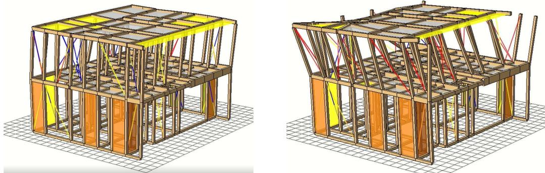
このように地震波に応じた建物の揺れが 3D で確認できます。部材の損傷ぐあいが色で表示されています。
