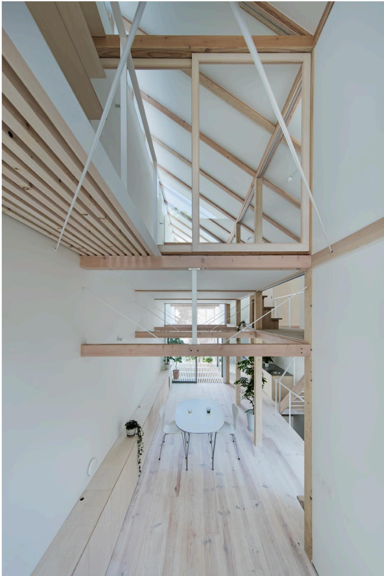
リビング吹抜よりベランダ方向を見る。床のずれを生かして合成梁の梁せいを確保し、120角の柱梁で軽やかな構造体を構成している。水平方向と垂直方向の抜けが同時に現れる空間。
