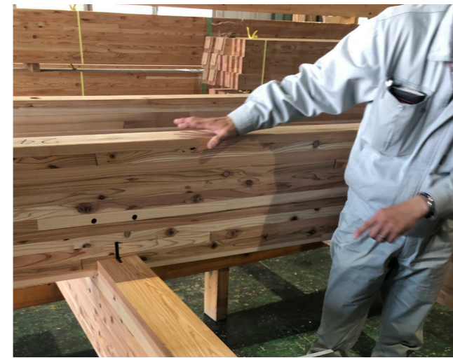
工場加工の風景。木材は静岡県産材のスギ集成材 120×360 を使用。
